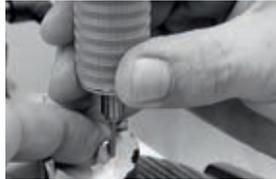
Abb. 5: Fräsen der Teleskope
