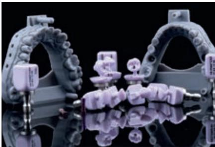
Abb. 1: Subtraktive Herstellung von vollkeramischen Restaurationen aus Lithiumdisilikat.
