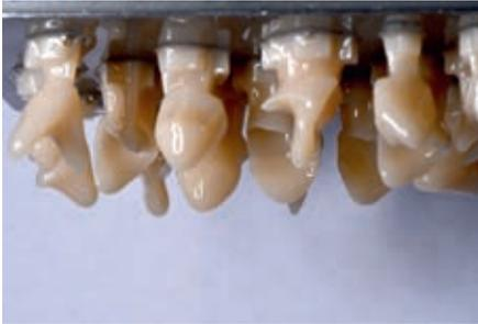
Abb. 5: 3D-gedruckte, nicht-invasive Restaurationen direkt nach der Fertigstellung. Die Supportstrukturen sind noch zu erkennen.
